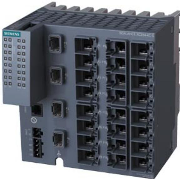
SCALANCE XC224-4C G managebarer Layer 2 IE Switch; IEC 62443-4-2 zertifiziert; Full-Gigabit; 20x 10/100/1000 Mbit/s RJ45-Ports; 4x 1000 Mbit/s Comboports (Entweder 1000 Mbit/s SFPs oder 10/100/1000 Mbit/s RJ45 Ports nutzbar); 1xKonsolen-Port; Diagnose-LED; redundante Spannungsversorgung; Temp.-Bereich-40°C bis +70°C; Montage: Hut-/S7-Profilschiene/Wand; Redundanzfunktionen; Office Features (RSTP, VLAN ,...); PROFINET IO-Device; Ethernet/IP-konform; C-PLUG Schacht;
