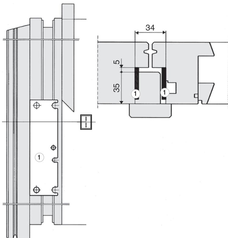
1) Unterlage für Schwingflügelager 4 mm (42686)
