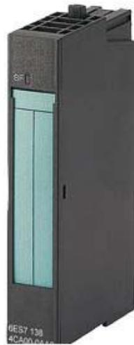
SIMATIC DP, ELEKTRONIKMODUL ET 200S: 2 AI HIGH SPEED U, 15 BIT, 15MM BAUBREITE, ZYKLUSZEIT DES MODULES: 0,1MS, MIT LED SF (SAMMELFEHLER)
