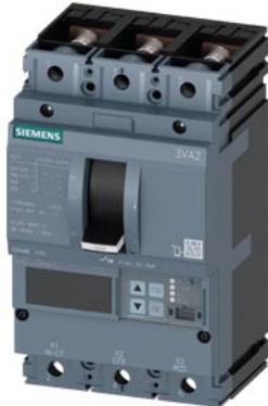
Leistungsschalter 3VA2 IEC Frame 160 Schaltvermögenklasse H Icu=85kA @ 415V 3-polig, Anlagenschutz ETU850, LSI, In=63A Überlastschutz Ir=25A...63A Kurzschlusschutz Isd=0,6..10x In, li=1,5..12x In N-Leiterschutz optional mit externem Stromwandler, bis 160% Schraubenflanschanschluss
