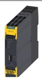
SIRIUS SICHERHEITSSCHALTGERAET GRUNDGERAET ADVANCED REIHE RELAIS-FREIGABEKREISE 3 SCHLIESSER + RELAIS-MELDEKREIS 1 OEFFNER US = 24 V DC SCHRAUBANSCHLUSS
