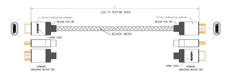
NOTE: E314459 兄 AWM 20276 80℃ 30V VW-1 HIGH SPEED HDMI<sup>®</sup> CABLE WITH ETHERNET
