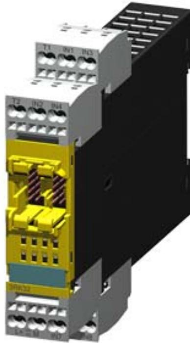
SIRIUS, Erweiterungsmodul 3RK32 für modulares Sicherheitssystem 3RK3 2/4 F-DI, 2 F-DO, DC 24 V/1,2 A parametrierbar über MSS ES 22,5 mm Baubreite Federzugklemme bis SIL3 (IEC 61508) bis Performance Level E (ISO 13849-1) ohne Verbindungskabel
