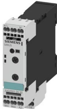
Analoges Überwachungsrelais Füllstandsüberwachung Widerstandsüberwachung von 2 bis 200 kOhm Über- und Unterschreitung Versorgungsspannung AC/DC 24 V DC und AC 50 bis 60 Hz ohne galvanische Trennung zum Messkreis 2 Punkt- oder 1 Punktregelung Auslöseverzögerung 0,5 bis 10 s 1 Wechsler Federzugtechnik
