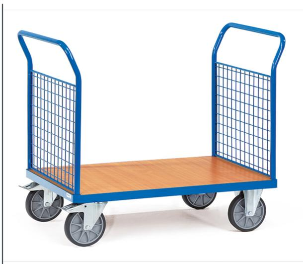
Ensemble mécano-soudé, revêtement époxy bleu RAL 5007, plateau en mélaminé surface effet hêtre avec ridelles en treillis métallique 50 x 50 x 4 mm, hauteur 500 mm. 2 roues pivotantes et 2 roues fixes à bandage TPE, moyeu à roulement à billes central. Freins sur roues pivotantes conformément à la Norme 1757-3 (Sécurité des chariots de manutention).
