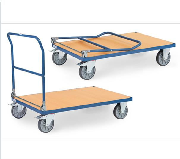
Klappwagen aus Stahlrohr und Profilstahl geschweißt, pulverbeschichtet brillantblau RAL 5007. Ladefläche aus Holzwerkstoffplatte, Oberfläche Buchendekor. Schiebebügel auf Plattform klappbar. 2 Lenk- und 2 Bockrollen, TPE-Bereifung (spurlos), Naben mit Rillenkugellager. Feststeller an den Lenkrollen, gemäß der Europäischen Norm EN 1757-3 (Sicherheit von Plattformwagen).
