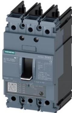
Leistungsschalter 3VA5 UL Frame 125 3-polig, Starterschutz TM120M, AM, In=80A ohne Überlastschutz Kurzschlusschutz Ii=5...12 x In ohne Anschluss
