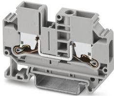
Durchgangsklemme, Nennspannung: 1000 V, Nennstrom: 41 A, Anzahl der Anschlüsse: 2, Polzahl: 1, Anschlussart: Push-X-Anschluss, Bemessungsquerschnitt: 6 mm<sup>2</sup>, Querschnitt: 0,5 mm<sup>2</sup> - 10 mm<sup>2</sup>, Montageart: NS 35/7,5, NS 35/15, Farbe: grau
