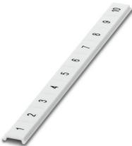
Zackband flach, Streifen, weiß, beschriftet, längs bedruckt: fortlaufende Zahlen 1 ... 10, 11 ... 20 usw. bis 101 ... 110, Montageart: verrasten, für Klemmenbreite: 8 mm, Schriftfeldgröße: 5,15 x 8,15 mm, Anzahl der Einzelschilder: 10
