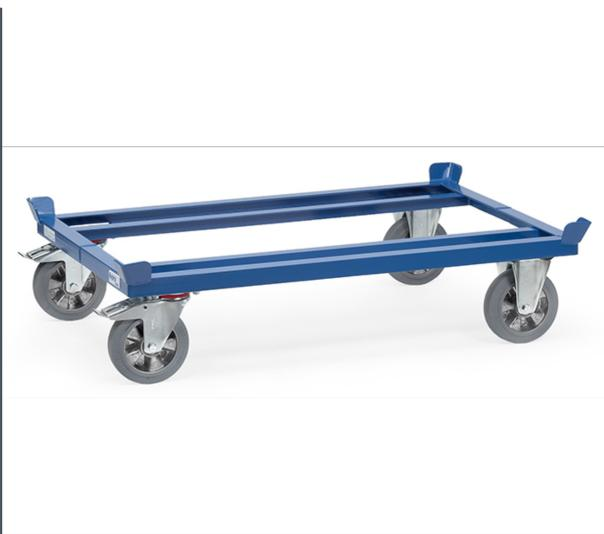
Für Flachpaletten und Gitterboxen. Robuste Winkelstahl-Schweißkonstruktion, mit 4 Fangecken, pulverbeschichtet, blau RAL 5007. 2 Lenk- und 2 Bockrollen, Elastic-Vollgummi-Bereifung, Naben mit Kugellager, blaugrau "spurlos", Feststeller an den Lenkrollen, gemäß der europäischen Norm EN 1757-3 (Sicherheit von Plattformwagen). Geringer Rollwiderstand, elastischer Lauf, keine Fahrgeräusche.
