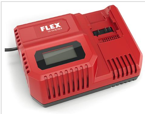
Zum Laden von 10,8 und 18,0 V Akkupacks. Mit großformatigem LCD Display für Batteriediagnostik und Ladezustand. Ladezeit 10,8 V : ca. 40 min. für 2,5 Ah / für 4,0 Ah und ca. 55 min. für 6,0 Ah Akkus. Ladezeit 18 V: ca. 40 min für 2,5 Ah und ca. 45 min für 5,0 Ah. Durch ein spezielles Ladeverfahren werden 80% der Ladekapazität nach ca. 30 min erreicht. Mit integrierter Akkupackkühlung, Überhitzungs-, Entladungs- und Überlastschutz.
