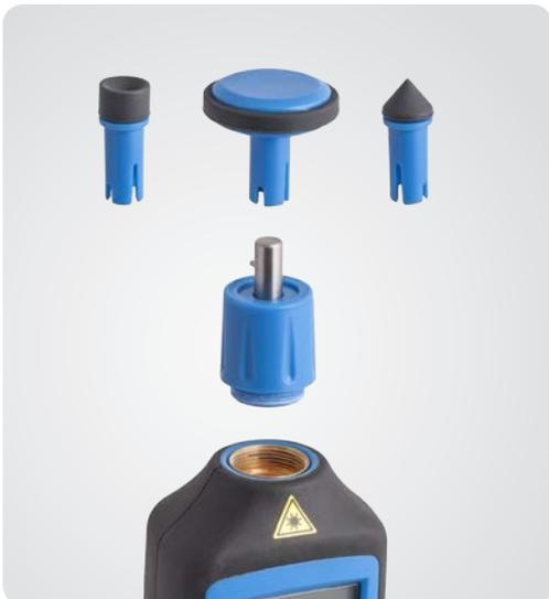
Neben einem Laser gehören mehrere Kontaktfühler zum Lieferumfang
