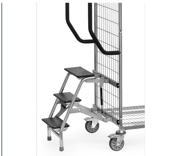
3 Marches, la plus haute à 600 mm, Hauteur de prise 2.800 mm. Poignée en acier, marche en bois antidérapant. Peut être déplacé en position basse sinon il reste bloqué par le poids de l'utilisateur. Une butée empêche le chariot de basculer. Le marchepied peut être facilement escamoté grâce à un vérin à gaz. En même temps que le marchepied sont livrés des poignées adaptées, plus grandes. La longueur totale est rallongée de 100 mm. Non livrable avec timon et attache.
