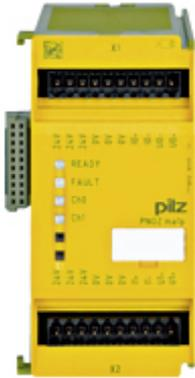
PNOZmulti Classic, Erweiterungsmodul, Failsafe, 2 analoge Eingänge, -10,24 - 10,23 V, zweipolig, Differenzeingang, Auflösung 13 Bit, 0 - 25,59 mA, zweipolig, Differenzeingang, Auflösung 12 Bit, Bereichsüberwachung, Schwellwertüberwachung.
