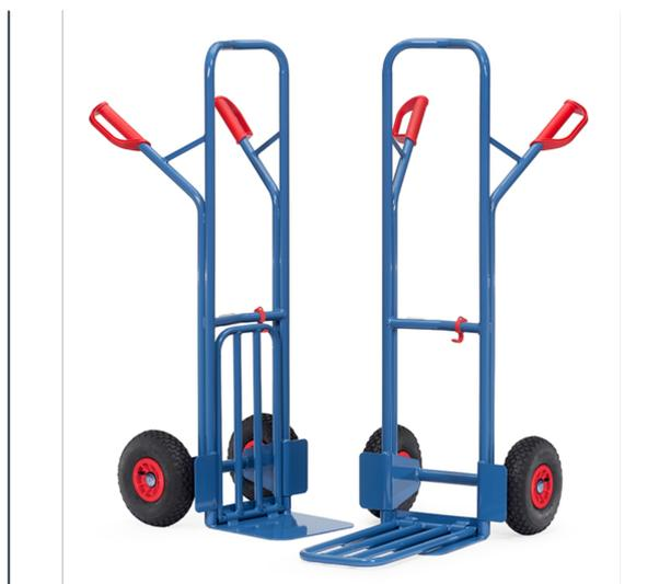
Ensemble mécano-soudé en tube d'acier, revêtement époxy bleu RAL 5007. Tablier cintré permettant d'embarquer des éléments ronds tels que rouleaux, bidons, seaux etc. Bavette fixe et rabattable, poignées de sécurité en plastique dur avec arceaux de sécurité. Roues gonflables sur jante en plastique, moyeu à roulement à rouleaux. Livré avec bavette démontée.
