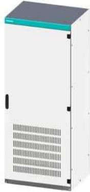
SIVACON, Schaltschrank- Leergehäuse, nach IEC 62208, mit Lüftungsöffnungen, IP20, H: 2000 mm, B: 400 mm, T: 800 mm
