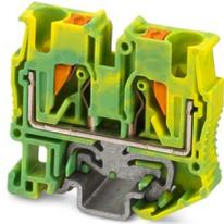
Mini-Schutzleiterklemme, Polzahl: 1, Anschlussart: Push-in-Anschluss, Bemessungsquerschnitt: 4 mm<sup>2</sup>, Querschnitt: 0,2 mm<sup>2</sup> - 6 mm<sup>2</sup>, Montageart: NS 15, Farbe: grün-gelb
