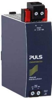
Das YR40.245 ist ein 40A-Einkanal-Redundanzmodul, das mit einem Steckverbinder am Ausgang ausgestattet ist. Der Steckverbinder ermöglicht den Austausch der Stromversorgung oder des Redundanzmoduls, während das System in Betrieb ist. Der Steckverbinder verhindert, dass die Ausgangsdrähte den Lastkreis berühren und kurzschließen.
