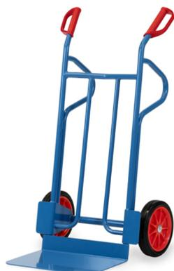
Ensemble mécano-soudé en tube et tôle d'acier, revêtement époxy bleu RAL 5007. Poignées de sécurité en plastique dur avec arceaux de sécurité. Bavette en tôle d'acier à boulonner et remplaçable. Roues à bandage caoutchouc, moyeu à roulement à rouleaux. Livré avec bavette démontée.
