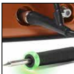
Der Lötgriffel zeigt dem Anwender über eine LED "gute" Lötverbindungen an.
