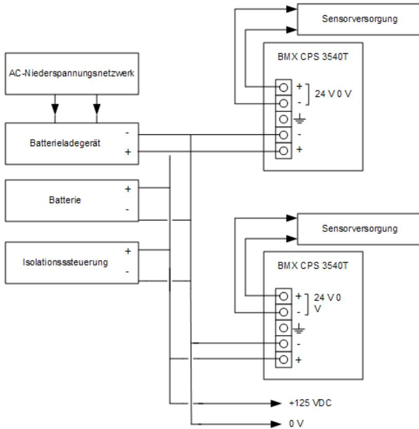
Potentialfreies 125-VDC-Netzwerk für die Spannungsversorgung der Sensoren, Stellglieder und Ein-/Ausgangmodule
