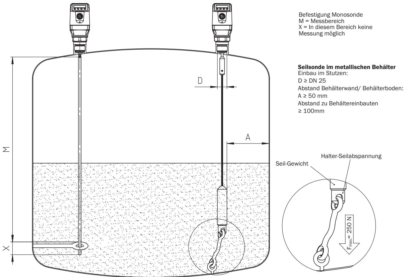
Einbau in ein metallisches Tauchrohr oder metallischen Bypass
