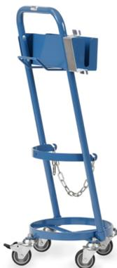
Construction en tube d'acier soudé, revêtement époxy bleu RAL 5007. Rouleur de bouteilles avec chaîne de maintien et poignée d'accrochage du tuyau et support de pistolet à gaz et appareil à flammes. Pour 1 bouteille de propane de 11 kg, Ø 300 mm. 4 roues pivotantes à bandage caoutchouc 75 x 25 mm, moyeu à roulement à rouleaux. 2 roues avec freins.
