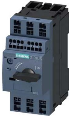
Leistungsschalter Baugröße S00 für den Motorschutz, CLASS 10 A-Auslöser 1,4...2 A N-Auslöser 26 A Federzuganschluss Standardschaltvermögen mit querliegenden Hilfsschalter 1S+1Ö
