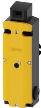
Sicherheits-Positionsschalter mit Zuhaltung Zuhaltkraft 2600 N 5 Anfahrrichtungen Federkraftverriegelt Fluchtentriegelung von hinten und Hilfsentriegelung vorne Magnetspannung AC 230 V Überwachung Betätiger 2Ö/1S Überwachung Magnet 2Ö/1S Lieferung ohne Betätiger. Betätiger 3SE5000-0AV0. bitte separat bestellen
