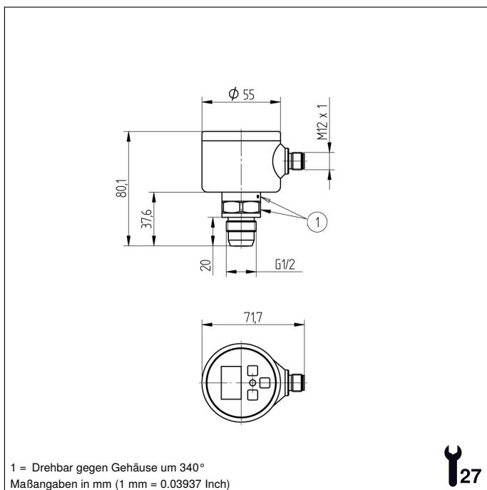
1 = Drehbar gegen Gehäuse um 340°
