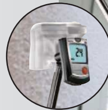
Einfaches Ablesen der Messwerte durch flexibles Gelenk
