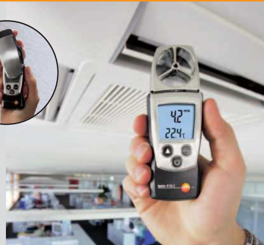
Strömungsmessung am Kanalauslass mit 40 mm-Flügelrad
