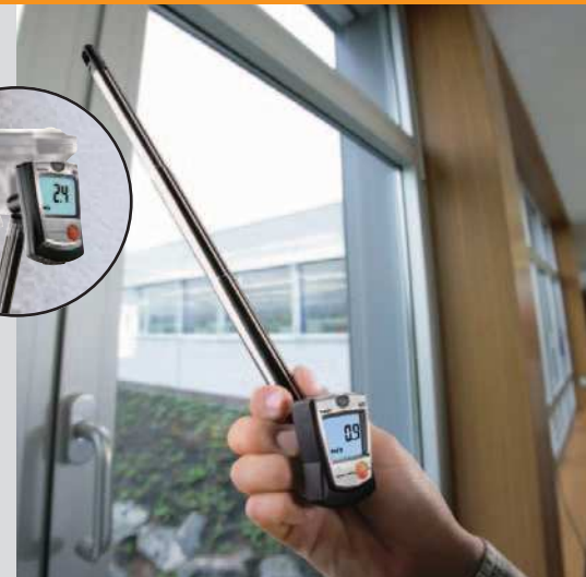
Strömungsmessung an undichten Fenstern
