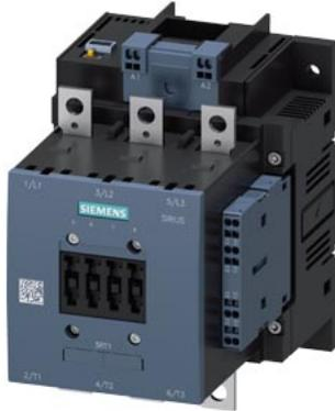
Leistungsschütz, AC-3e/AC-3 115 A, 55 kW / 400 V, AC (50-60 Hz) / DC Uc: 200-277 V SPS Eingang 24 V DC 3-polig, Hilfskontakte 2 S + 2 Ö Antrieb: elektronisch Hauptstr.: Schiene Steuer- und Hilfsstromkreis: Federzuganschluss
