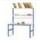
table d'emballage complète, hauteur x largeur x profondeur 850 x 1600 x 800 mm, panneau en acier avec revêtement en plastique résistant à l'usure finition gris clair, piètement 4 pieds en acier avec finition époxy résistante aux chocs et aux rayures en RAL5017 bleu signalisation, 1 dispositif dérouleur, 2 tablettes, 8 manches insérables
