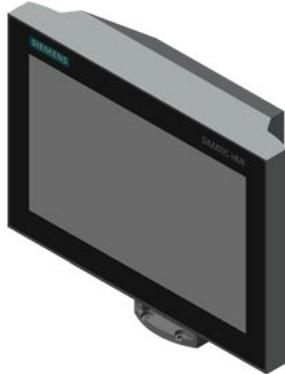
SIMATIC IFP1200 V2 PRO; 12" Multitouch Display(16:10) mit 1280x800 Pixel Auflösung; PRO-Variante Standfuß; für 24V DC; DisplayPort Schnittstelle; bis 100m absetzbar HDBaseT, rückseitige USB, Standard Design
