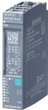
SIMATIC ET 200SP, TM SIWAREX WP321 ST, einkanalige Wägebaugruppe für Plattform- oder Behälterwaagen mit analogen Wägezellen / Dehnungsmesstreifen (Vollbrücken), 1xRS485, 1xLC Wägezellen-Schnittstelle (1-4mV/V), passend für BU-Typ A0, Verpackungsmenge: 1 Stück, Detaillierte Wägezellendiagnose mit digitalem Anschlusskasten SIWAREX DB (7MH5001-0AD20 oder 7MH5001-0AD01) möglich.
