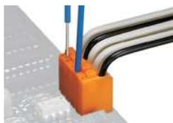
Prüfen mit Prüfstift Ø 1 mm
