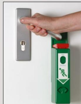
Beim Durchdrücken der Türklinke verschiebt sich der EH-Türwächter automatisch nach unten und ermöglicht mit nur einem Handgriff das Begehen der Notausgangstür. Dabei wird ein Daueralarm ausgelöst, der mit dem Geräteschlüssel gelöscht werden kann.
