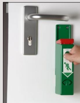
Mit dem Geräteschlüssel kann der Türwächter durch Verschieben nach unten alarmfrei in eine Dauer-Offen-Position gebracht werden. In dieser Position ist die Tür normal zu begehen.
