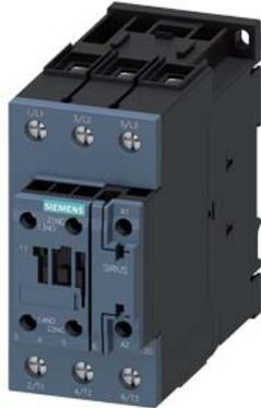
Bahnschütz, AC-3e/AC-3, 65 A, 30 kW / 400 V, 3-polig, DC 24 V, 0,7-1,25\* US, elektronischer Antrieb, mit integriertem Varistor, Hilfskontakte: 1 S + 1 Ö, Schraubanschluss, Baugröße: S2
