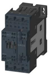
CONTACTOR, AC-3, 15KW/400V, 1NO+1NC, DC 24V, COM. CAPABILITY, 3-POLE, SZ S0 SPRING-LOADED TERMINAL
