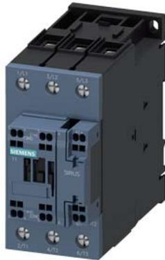
Bahnschütz, AC-3e/AC-3, 51 A, 22 kW / 400 V, 3-polig, DC 110 V, 0,7-1,25\* US, elektronischer Antrieb, mit integriertem Varistor, Hilfskontakte: 1 S + 1 Ö, Hauptstromkreis: Schraubanschluss, Steuer- und Hilfstromkreis: Federzuganschluss, Baugröße: S2
