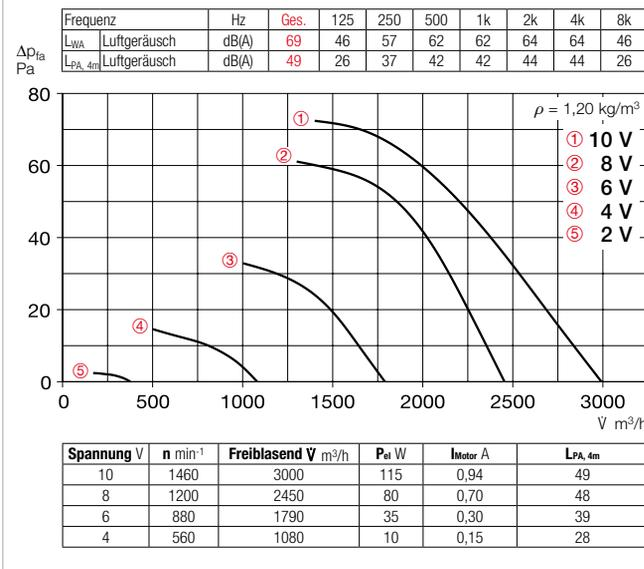
**Kennlinien HQ EC / HW EC / HRF EC 355 B**
