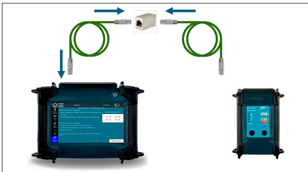
Abbildung 25 – Testaufbau zum Setzen der Referenz
