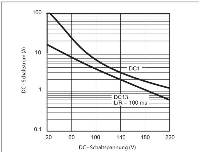
Bei ohmscher Last (DC1) oder induktiver Last (DC13) und einem Schnittpunkt von Strom und Spannung unter der Kurve kann von einer elektrischen Lebensdauer von > 30000 Schaltspielen ausgegangen werden.
