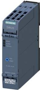
Thermistor-Motorschutzrelais Gerät für Warnen und Abschalten 22,5 mm Gehäuse Federzugklemme 1 Schliesser + 1 Wechsler US = AC/DC 24 V-240 V Hand/Auto/Fern-RESET mit ATEX-Zulassung 3 LEDs (READY/WARNING/TRIPPED) sichere galvanische Trennung Test-/RESET-Taste Drahtbruchüberwachung Kurzschlussüberwachung nullspannungssicher 2 getrennte PTC-Fühlerkreise
