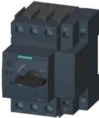
LEISTUNGSSCHALTER BGR. S00, FUER DEN MOTORSCHUTZ, CLASS 10, MIT UEBERLAST-RELAISFUNKTION A-AUSL.0,9...1,25A, N-AUSL.16A, SCHRAUBANSCHLUSS, STANDARDSCHALTVERMOEGEN
