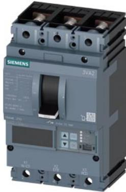
Leistungsschalter 3VA2 IEC Frame 250 Schaltvermögenklasse H Icu=85kA @ 415V 3-polig, Anlagenschutz ETU560, LSIG, In=160A Überlastschutz Ir=63A...160A Kurzschlusschutz Isd=0,6..10x In, li=1,5..12x In N-Leiterschutz optional mit externem Stromwandler, bis 160% Erdschlusschutz, abschaltbar Ig=0,2...1 x In, tg=0,05-0,8s Schraubenflachanschluss
