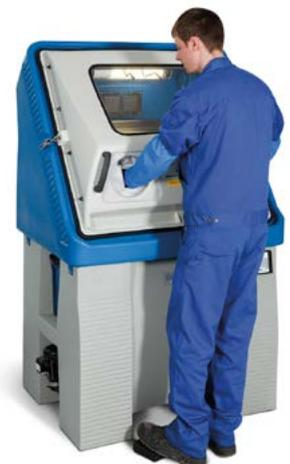
**Der Reinigungstisch bio.x T700 ist mittels Haube verschließbar. Dies ermöglicht das sichere, spritzgeschützte Säubern.**
