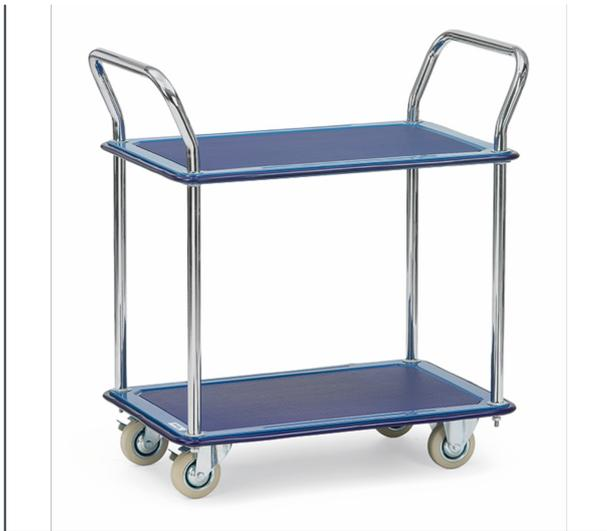
Tischwagen mit 2 Plattformen aus Stahlblech gepresst, pulverbeschichtet brillantblau RAL 5007. Mit aufgeklebtem Antirutschbelag und umlaufender Schutzleiste. Rohrschiebebügel feststehend, glanzverzinkt. 2 Lenk- und 2 Bockrollen, Vollgummi-Bereifung, Feststeller an den Lenkrollen, gemäß der Europäischen Norm EN 1757-3. Zerlegte Anlieferung. Tragkraft obere Ladefläche 60 kg.
