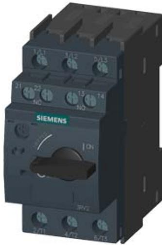
LEISTUNGSSCHALTER BGR. S00, FUER DEN MOTORSCHUTZ, CLASS 10, A-AUSL.0,55...0,8A, N-AUSL.10A, SCHRAUBANSCHLUSS, STANDARDSCHALTVERMOEGEN, MIT QUERL. HILFSSCHALTER 1S+10E
