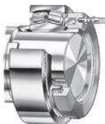
Bild 7. Herausziehen einer Abziehhülse aus einer kegeligen Lagerbohrung
