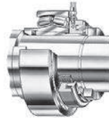
Bild 8. Ausbau eines Lager auf Spannhülse mit einer auf dem Hülsengewinde montierten Hydraulikmutter, die gegen einen Anschlag auf der Welle abgestützt ist.
