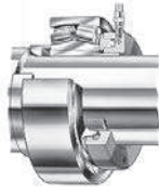
Bild 4. Einbau eines gegen einen Anschlag abgestützten Lagers auf Spannhülse
