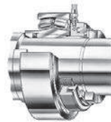
图8. HMV液压螺母和止动环用于松开紧定套
