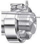
Bild 3. Einbau eines Lagers direkt auf kegeligem Sitz
