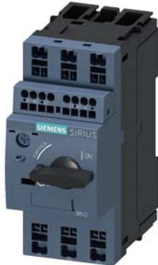
Leistungsschalter Baugröße S00 für den Motorschutz, CLASS 10 A-Auslöser 0,9...1,25 A N-Auslöser 16 A Federzuganschluss Standardschaltvermögen mit querliegenden Hilfsschalter 1S+1Ö
